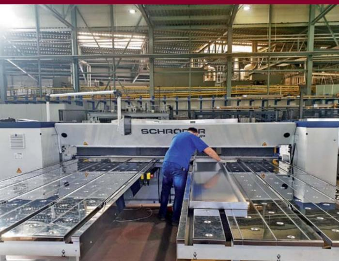
**Neue Schwenkbiegeanlage für Metalit**
