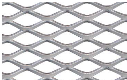
Masche 30 x 15 x 4 x 1,5 [mm] Mesh freier Querschnitt ca. 46,3% free cross-section approx.
