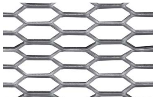
Masche 44 x 10 x 2 x 1,5 [mm] Mesh freier Querschnitt ca. 60,0% free cross-section approx.
