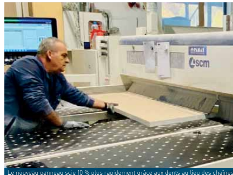
Le nouveau panneau scie 10 % plus rapidement grâce aux dents au lieu des chaînes.
