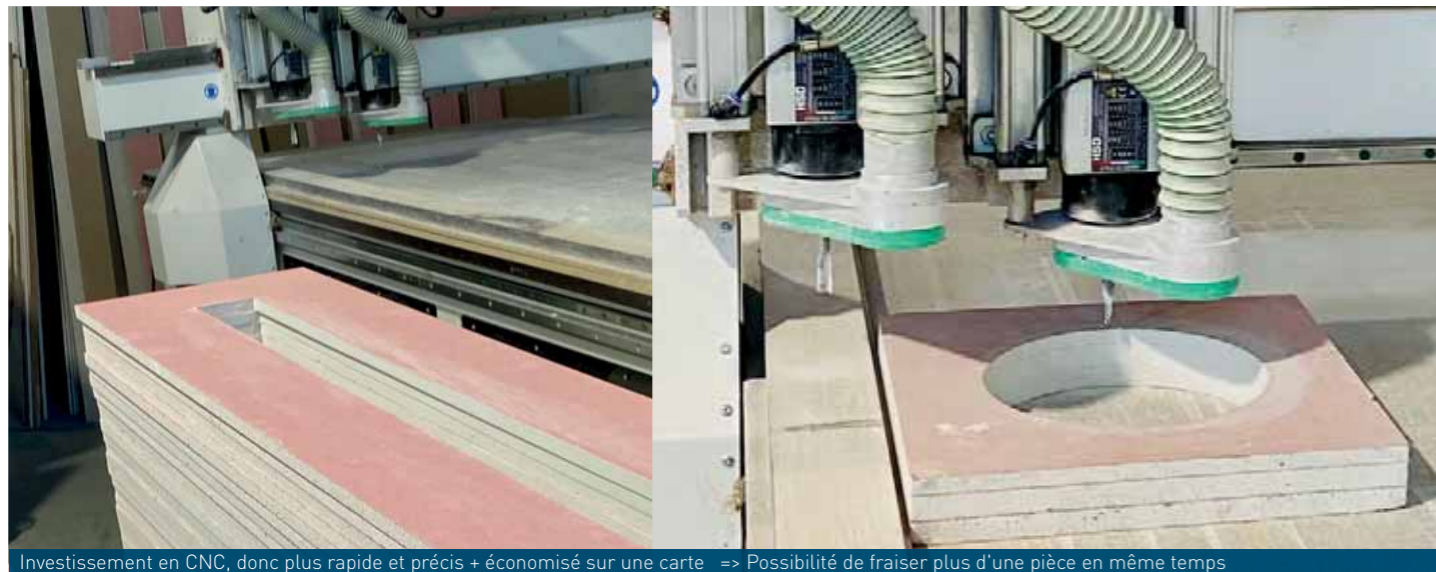
Investissement en CNC, donc plus rapide et précis + économisé sur une carte => Possibilité de fraiser plus d'une pièce en même temps
