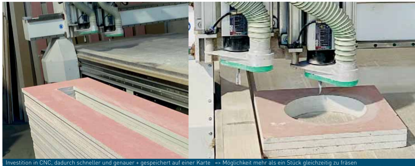
Investition in CNC, dadurch schneller und genauer + gespeichert auf einer Karte => Möglichkeit mehr als ein Stück gleichzeitig zu fräsen
