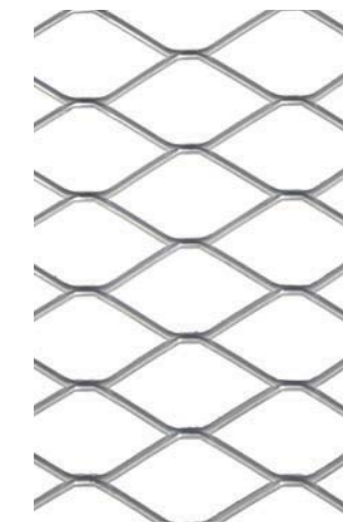
velká oka 1 L 60,0 mm W 32,0 mm B 3,0 mm A 1,5 mm F o 81,3 %
